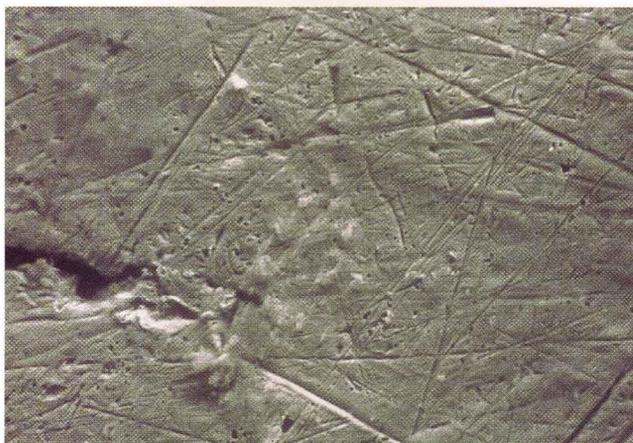
**Fig. 10** Immagine al SEM del margine coronale con fori dovuti alla biocorrosione (Ingrandimento 2000X)
