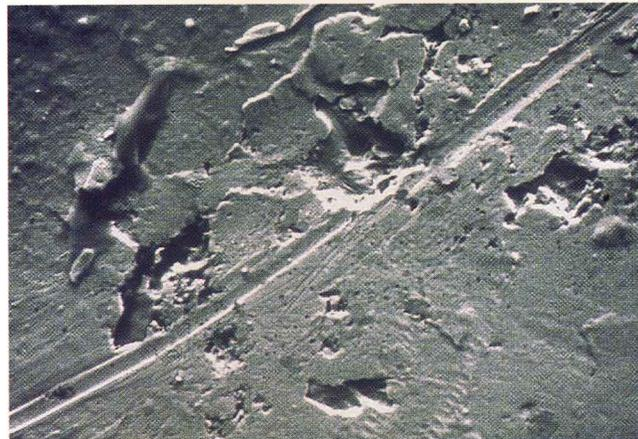
Fig. 5 Immagine al microscopio elettronico a scansione (SEM) delle viti recuperate. Chiare lesioni riferibili ai processi di biocorrosione. Ingrandimento 2000X
