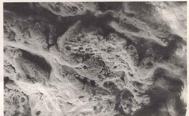
**Fig. 15** - Margine coronale corrosivo. La corona è stata ottenuta da una lega ad alto contenuto aureo. La corrosione è iniziata nella fessura tra spalla dell'impianto e margine della corona stessa. REM. Ingrandimento originale 1600X
