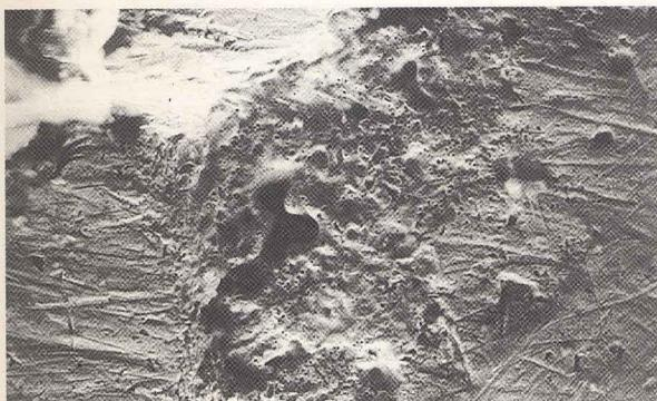
**Fig. 8** - Corrosione a fessura tra metallo e ceramica, caso 2. REM. Ingrandimento originale 800X
