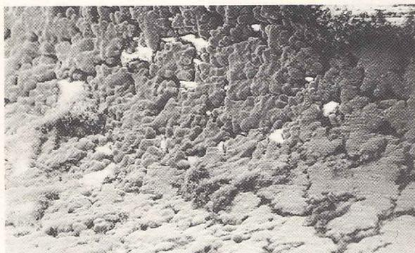
**Fig. 9** - Soluzione di continuo nella struttura metallica dovuta a corrosione, caso 2. REM. Ingrandimento originale 180X
