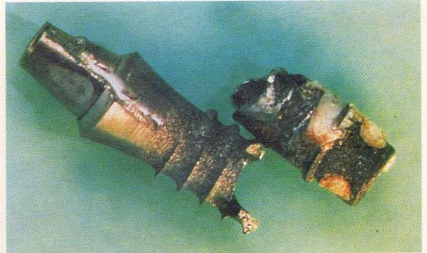
**Fig. 13** - Impianto in titanio fratturato per sovraccarico, caso 5. La parte più apicale è ancora in intimo contatto con il tessuto osseo (freccia). Microscopia ottica. Ingrandimento originale 6X
