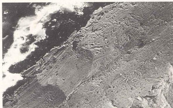
**Fig. 11** - Lega ad alto contenuto aureo. Nel passaggio tra ceramica e metallo si assiste ad un evidente fenomeno di corrosione, caso 4. REM. Ingrandimento originale 900X
