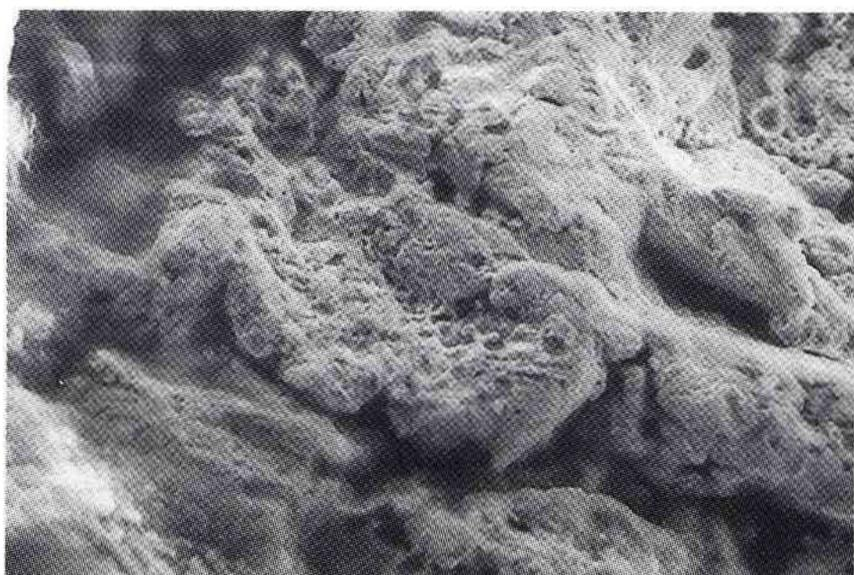
Abb. 15 Korrodierter Kronenrand (hochgoldhaltig) im Spalt zwischen Krone und Implantat. REM, Vergrößerung 1.600x
