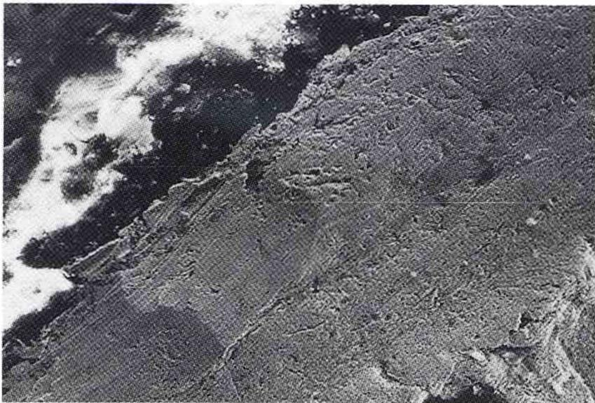
Abb. 11 Deutlich korrodierte hochgoldhaltige Edelmetallegierung am Übergang zwischen Keramik und Metall (Fall 4). REM, Vergrößerung 900x
